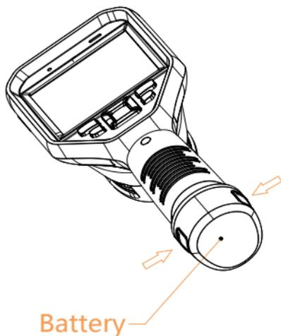
2. Halten Sie die Verriegelungen fest und ziehen Sie den Batteriesockel heraus, um die Batterie herauszunehmen (siehe Abbildung unten).
