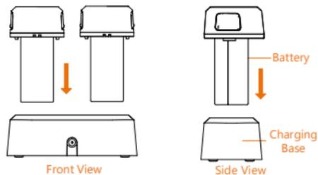
4. Wenn der Akku vollständig aufgeladen ist, ziehen Sie den Akku aus der Ladestation.
